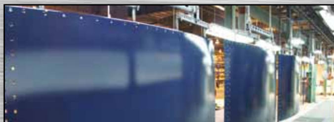
Etapa 4: Las placas de vidrio fusionado al acero pasan por el control de calidad y se preparan para su despacho.
