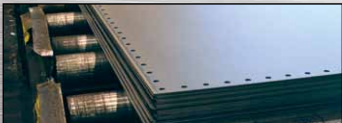
Etapa 1: Paneles de acero preparados según las especificaciones.
